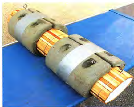
Рис. 1. Изготовленная модель футерованного трубопровода со съемными железобетонными кольцевыми утяжелителями:
